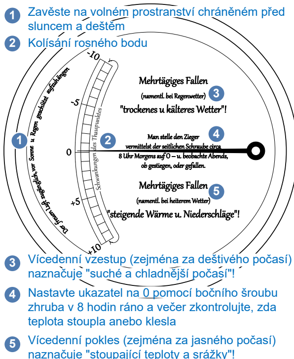
Obr. 16: Lambrechtův termo-hygroskop
